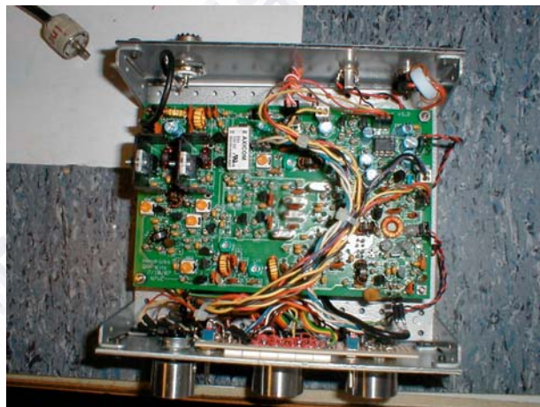
RTX analogo montato con un Kit statunitense
