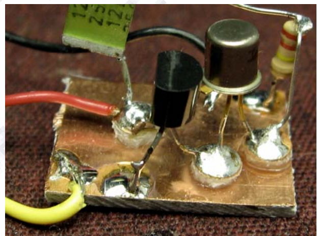
Oscillatore montato con tecnica manhattan by IK1BLK
