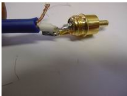
5- Saldare la parte centrale del connettore detto polo caldo
