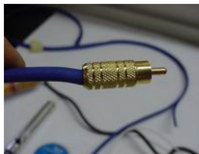
6- Dopo aver saldato la calza esterna nella linguetta del connettore, si rimonta il tutto.
