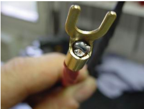
NO - Saldatura a freddo
