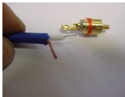
3- Aprire il polo centrale avendo cura che due cavi non vengano in contatto accidentale tra loro
